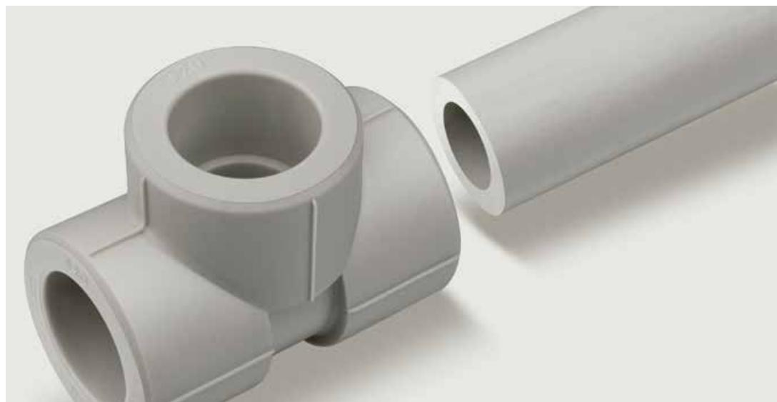
Pagrindinė KAN-therm PP Stabi kombiniuotose vamzdžiuose naudojamo sluoksnio funkcija yra ženklus, penkis kartus didesnis vamzdžių šiluminio pailgėjimo ribojimas ( $\alpha = 0,03 \text{ mm/m}\times\text{K}$ ; vienalyčių vamzdžių atveju  $\alpha = 0,15 \text{ mm/m}\times\text{K}$ ). Aliuminio sluoksnis dalinai apsaugo nuo deguonies difuzijos iš aplinkos.
