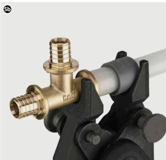
**5c.** Žiedą galima užtraukti pasitelkus įprastus elektrinius „Press“ tipo presus naudojant KAN-therm UltraLine adapterį, specialus adapteris, tiekiamas sistemos KAN-therm UltraLine asortimente. Jeigu žiedas ant fasoninės dalies užtraukinėjamas naudojant elektrinį presą, būtina stebėti montavimo eiga – movą pristūmus iki fasoninės detalės jungės reikia sustoti.
