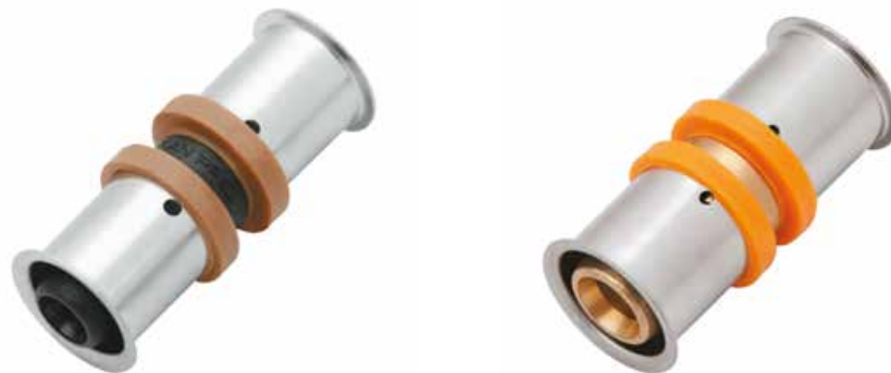
Pav. 44. KAN-therm Press LBP jungtis daugiasluoksniams vamzdžiams 14 × 2, 16 × 2, 17 × 2, 20 × 2, 25 × 2,5
