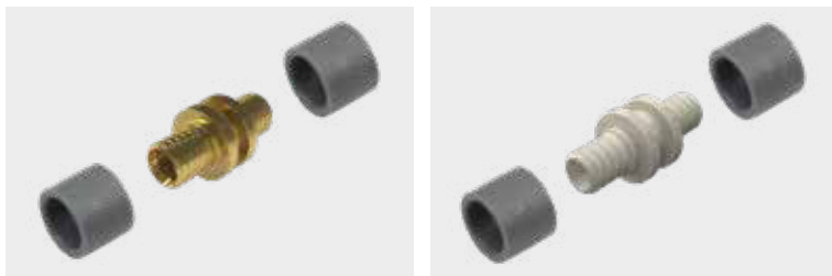
Pav. 50. KAN-therm ultraLINE jungtis PEXC, PERT 2 ir PERTAL 2 vamzdžiams, diametrai 14 × 2, 16 × 2,2, 20 × 2,8, 25 × 2,5 mm.
