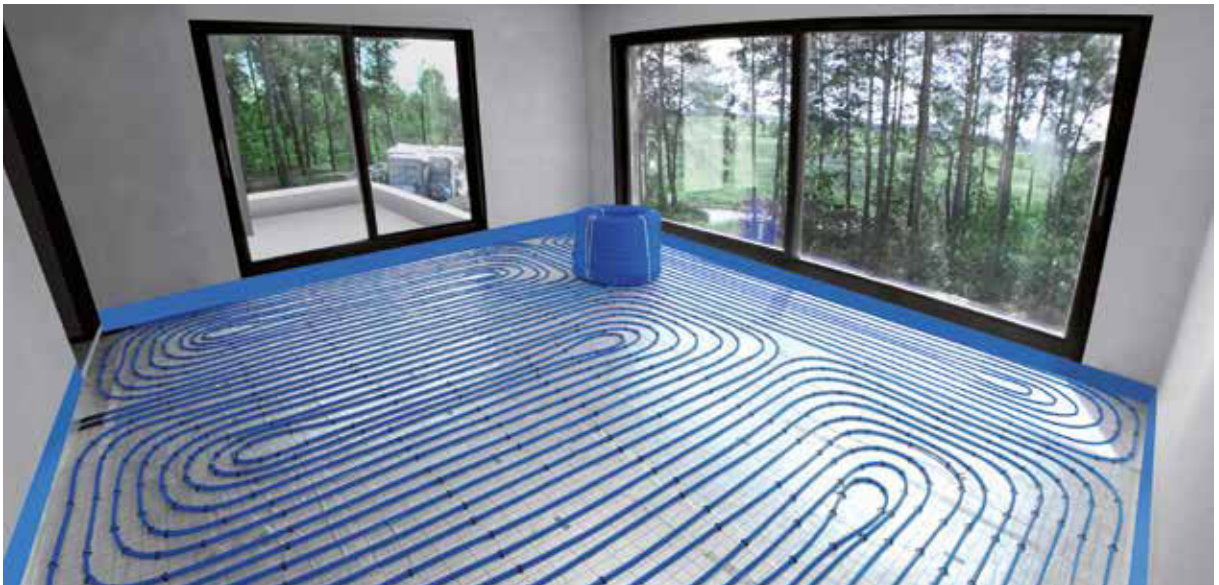
Pav. 3. Grindų šildymo sistema vienbučiame pastate, naudojant bluePERT vamzdžius ir KAN-therm Tacker sistemą.
