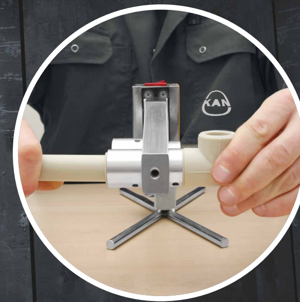
04 Vamzdžio ir jungiamosios detalės išilimas.
