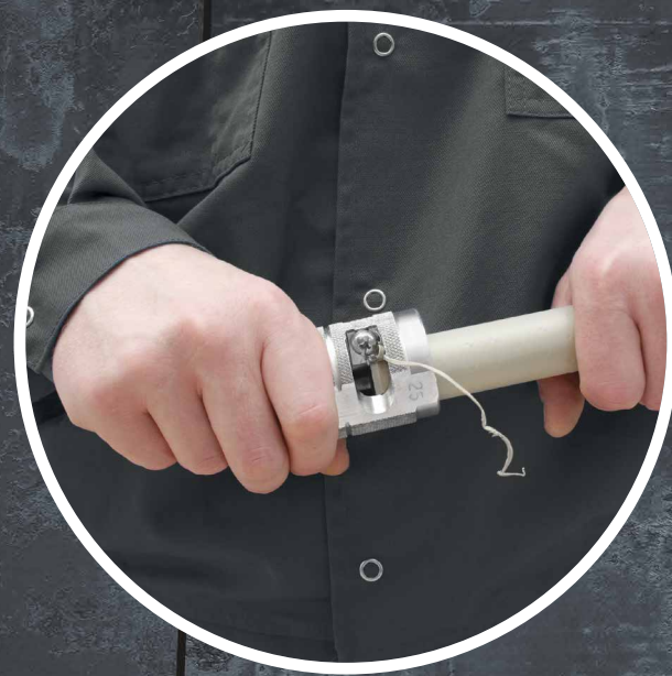
02 Aliuminio folijos pašalinimas drožtuku (stabiAL PPR kompozitiniai vamzdžiai).
